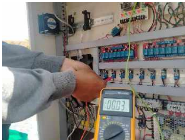
Gambar 4. 8 Hasil Pengujian Input Sensor tegangan Ketika Lampu Padam
