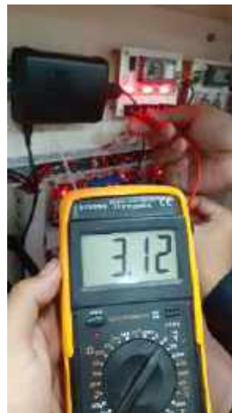
Gambar 3. 23 Pengukuran Output ESP32
