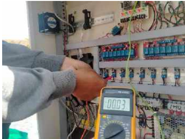
Gambar 3. 26 Pengujian Input Sensor tegangan Ketika Lampu Padam
