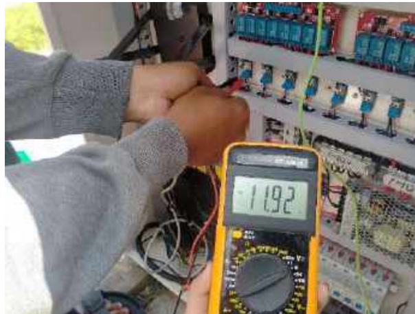
Gambar 3. 24 Pengujian Input Sensor tegangan Ketika Lampu Menyala
