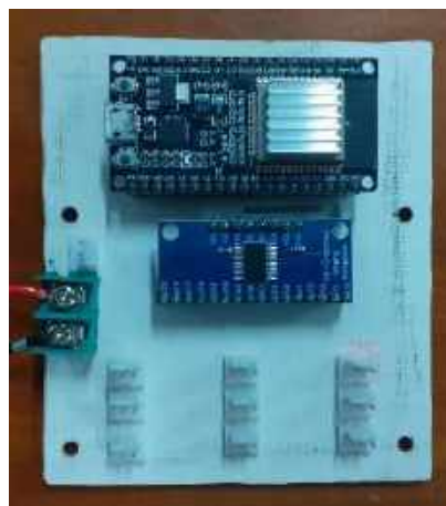
Gambar 3. 15 Pembuatan PCB Sensor Tegangan
