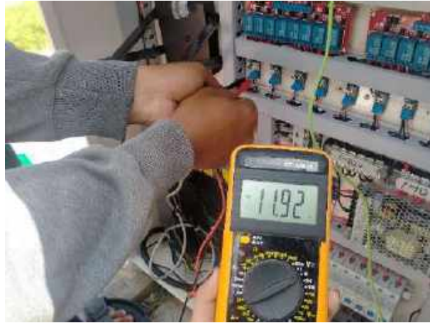
Gambar 4. 7 Hasil Pengujian Input Sensor Tegangan Ketika Lampu Menyala
